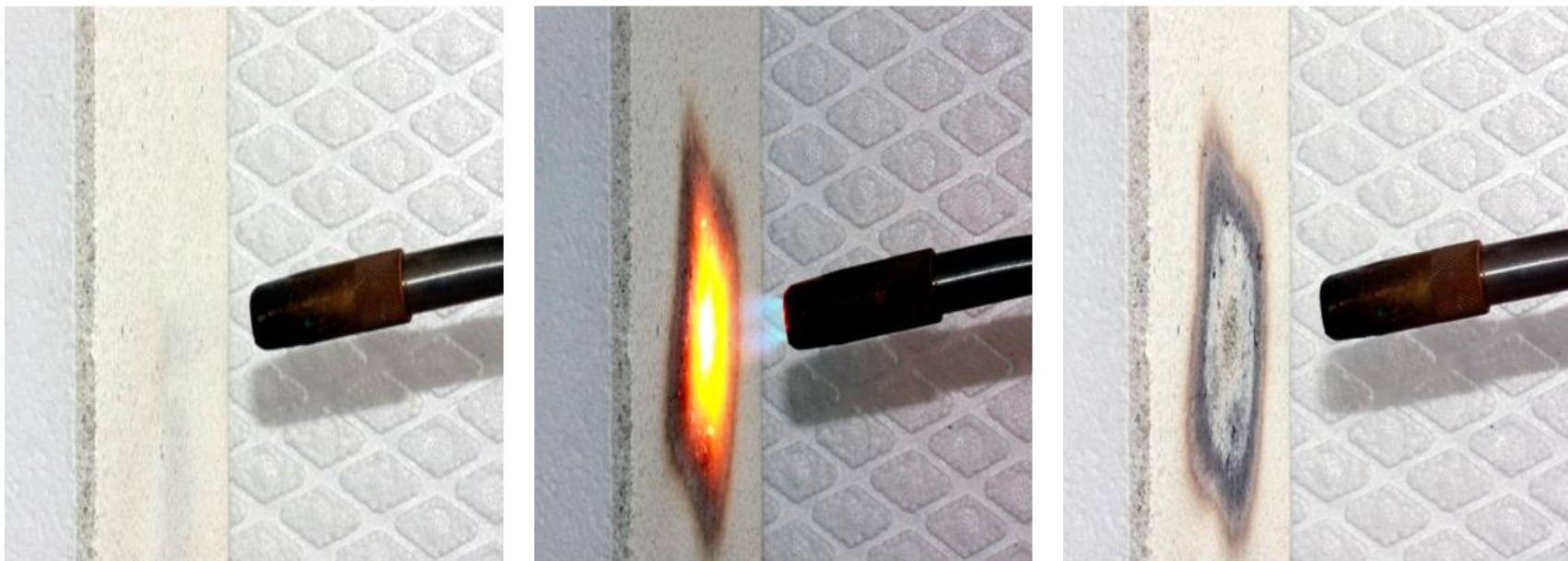
Secuencia de una prueba de exposición al fuego, sobre una capa de THERMOCAL de 5 mm de espesor como protección de un elemento de poliestireno expandido
